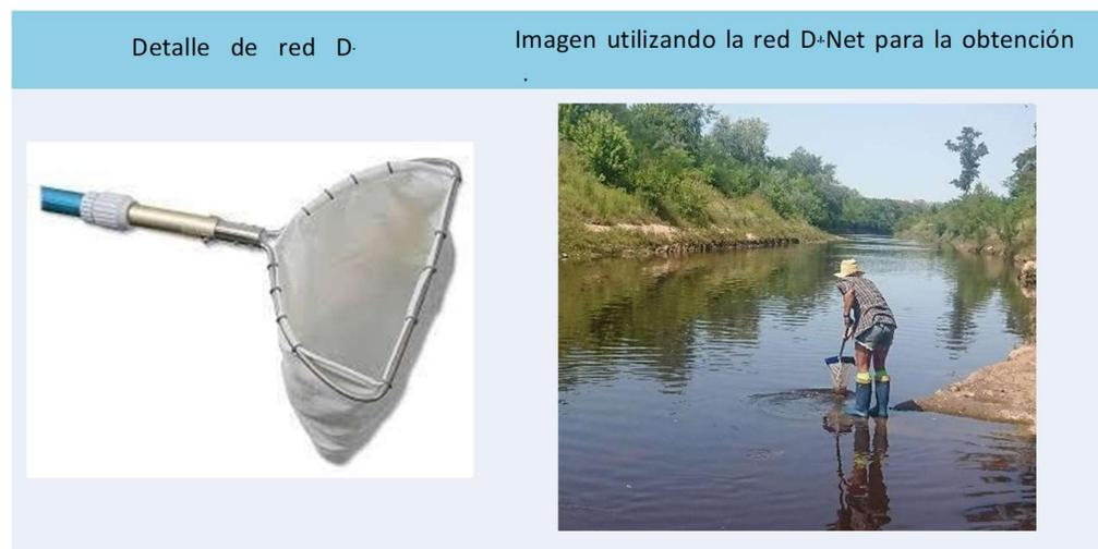
*Figura 7 – Detalles del muestreador a la izquierda y la metodología de uso en el campo a la derecha*
